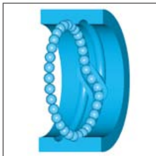
図3-5：内部リターンキャップ 用の回路
